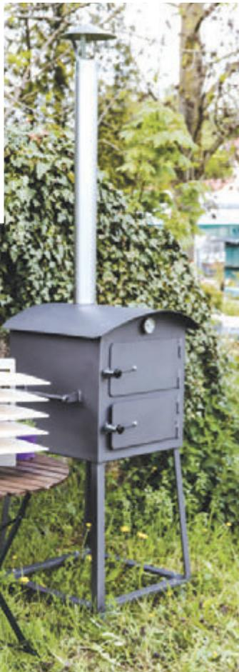
Unser Flammkuchenofen besteht aus 2,5 mm starkem, unbehandeltem Stahlblech und ist fertig verschweißt. Auf Wunsch kann ein hitzebeständiger schwarzer Lack als Korrosionsschutz aufgetragen werden. Wir empfehlen die Türscharniere regelmäßig zu ölen.
